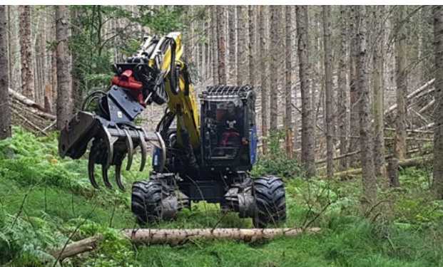
Schreitbagger beim Freischneiden von Wegen in den Richterschlüchten
