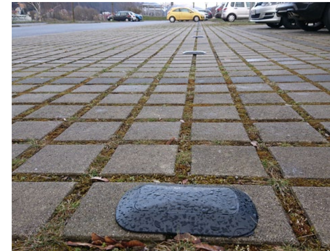
Parkplatzsensor P+R Bad Schandau
